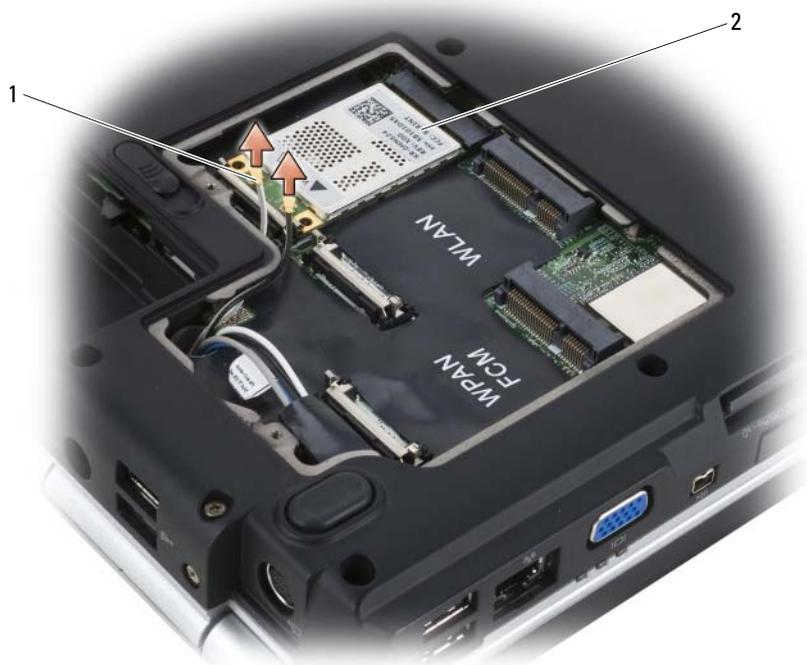
1 Conectores del cable de antena (2) 2 Tarjeta WWAN
