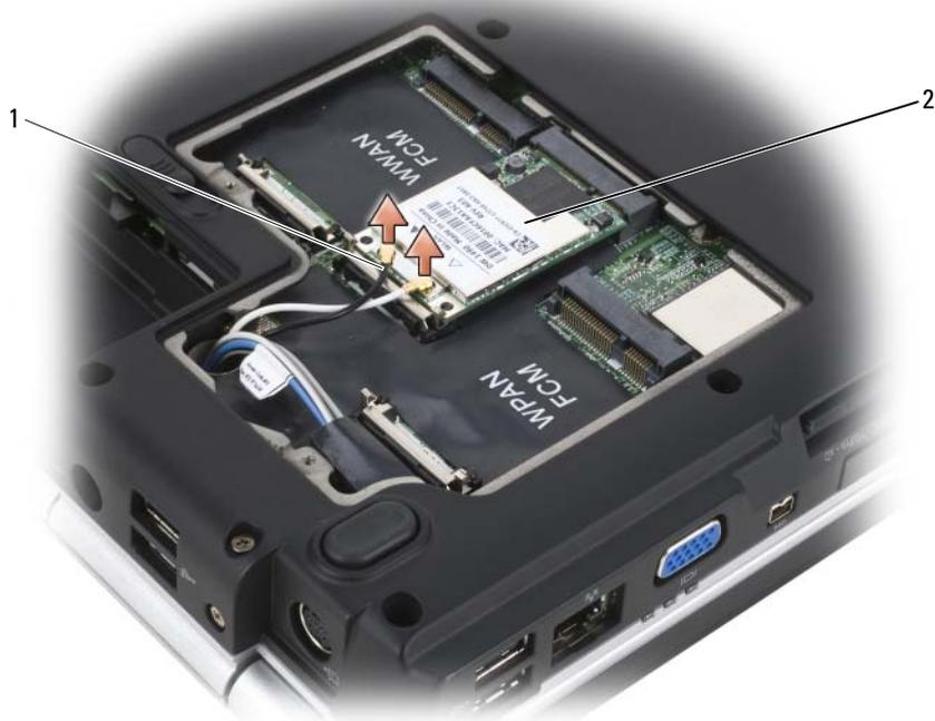
1 Conectores del cable de antena (2) Tarjeta WLAN
