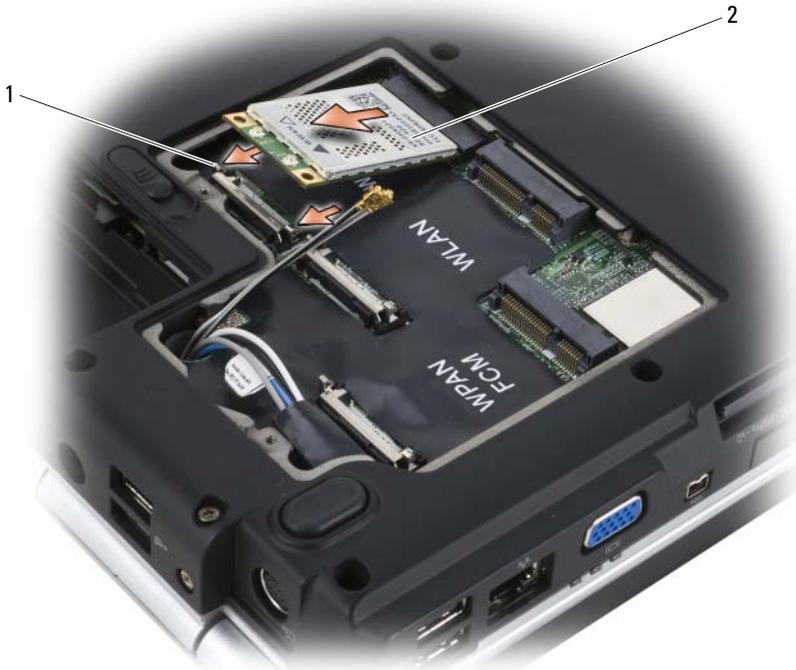
1 Lengüetas metálicas de sujeción (2) 2 Tarjeta WWAN
